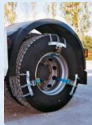
4 Tendre la chaîne (Nous conseillons aux utilisateurs, pour plus d'efficacité et de fiabilité, de tendre à nouveau les chaînes après avoir roulé quelques mètres.). Possibilités de monter jusqu'à 4 éléments.
