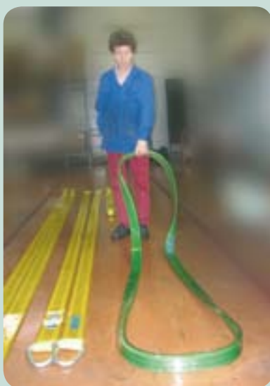
» Réalisation d'une enduction sur une élingue sangle plate sans fin.
