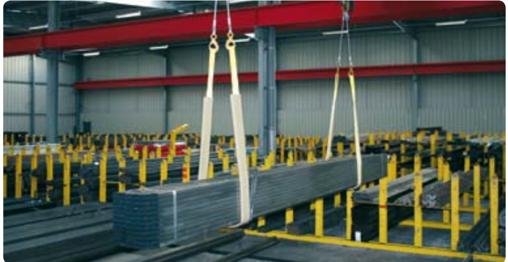
Le fourreau coulissant permet une parfaite mise en place et sans à-coup de la sangle.
