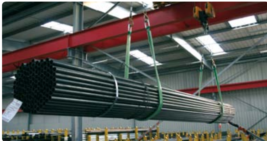
L'enduction polyuréthane améliore la durée de vie des sangles lors de la manutention d'objets lisses, comme des tubes ou des tuyaux.
