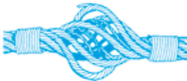
Cage d'oiseaux (câble à 6 torons) causée par des chocs lors de travail sous charge
