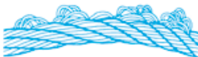
Un choc lors de travail sous charge, d'un couple survenu lors de l'installation, d'un coincement au passage sur une poulie, ou de l'utilisation inadéquate d'un câble au regard de l'application
